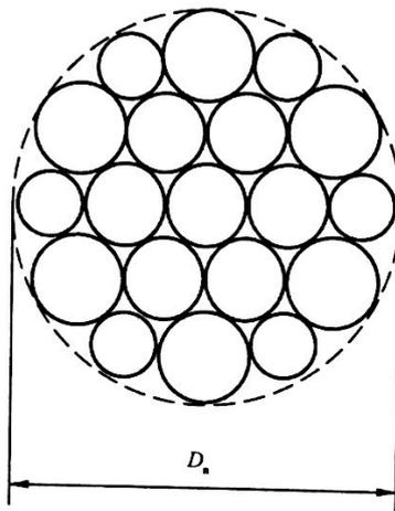
图 5 1×19 结构瓦林吞式钢绞线外形示意图
