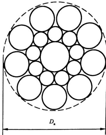
图 4 1×19 结构西鲁式钢绞线外形示意图
