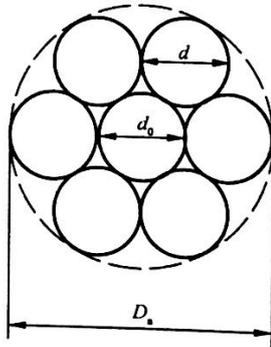
图 3 1×7 结构钢绞线外形示意图
