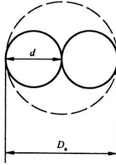
图 1 1×2 结构钢绞线外形示意图
