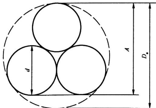
图 2 1×3 结构钢绞线外形示意图
